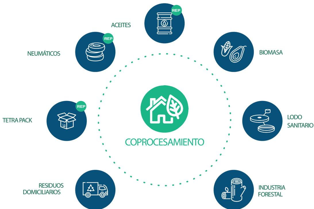
Una gran cantidad de residuos pueden ser aprovechados en la fabricación de cemento tanto como energía en el coprocesamiento o como adiciones para reducir el factor clínker.
