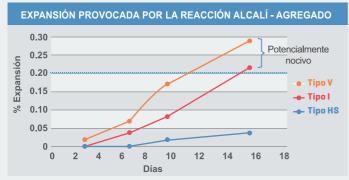
EL CEMENTO YURA ANTI-SALITRE TIPO HS inhibe esta reacción protegiendo al concreto contra este tipo de ataque.
