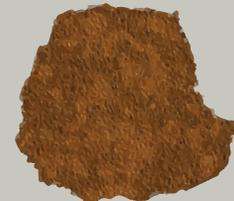
**Turba:** Material orgánico descompuesto con considerable suelo mineral. Usualmente de color negro con presencia de fibras. Tiene mal olor. Se encuentra como depósito en pantanos y ciénegas. Fácilmente identificable. Puede contener algo de arena o limo.
